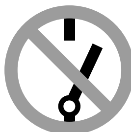
Abb. 4: Beispiel für ein Warnschild zum Sichern gegen Wiedereinschalten
