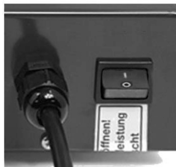
Abb. 22: Einschalten der Steuerung
